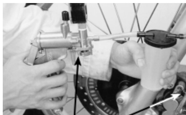
SANGRADOR DE FREIO VÁLVULA DE SANGRIA
